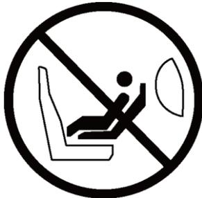
**Advertencia:** Los anclajes de los sistemas de retención infantil están diseñados para soportar únicamente las cargas adecuadas para los sistemas de retención infantil correctamente instalados. En ningún caso deben utilizarse para cinturones de seguridad de los adultos, arneses ni para fijar otros elementos o equipos al vehículo.
