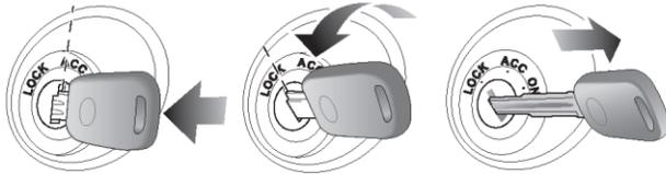
Para sacar la llave del interruptor de encendido, gire la llave a la posición ACC. A continuación, presione la llave hacia el interruptor de encendido y siga girándola hasta la posición LOCK. En ese momento podrá sacar la llave.
