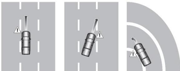
Si está activado el LDWS, si el vehículo circula a una velocidad de 72 km/h o superior y el sistema detecta la línea del carril
