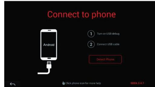
Toque **Detect Phone** (Detectar teléfono) para realizar la conexión; si se produce un fallo en la conexión se emitirá el aviso de conexión fallida que se muestra a continuación:
